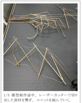
対数関数で曲面を生成し、テンセグリティ構造のフレームを作成。Kangaroo で張力・圧縮材をシミュレーションし、形状を最適化して出力する。
