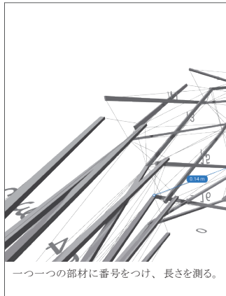
対数関数で曲面を生成し、テンセグリティ構造のフレームを作成。Kangaroo で張力・圧縮材をシミュレーションし、形状を最適化して出力する。
