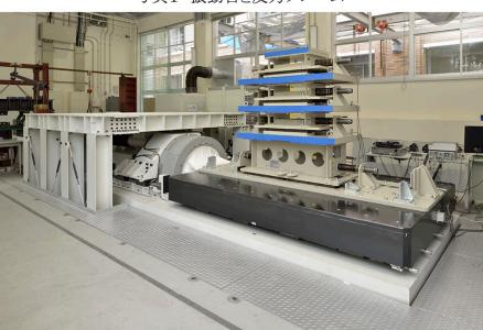
写真2 振動台と振動模型
