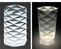
図3 吉村パターン(左)と谷折り線なし吉村パターン(右)
