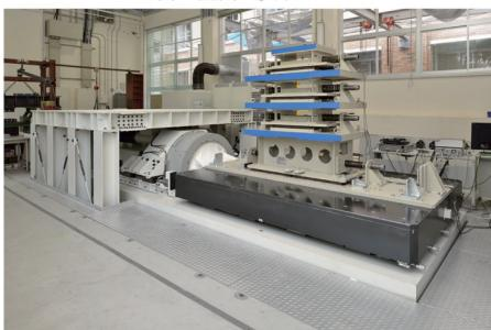
写真2 振動台と振動模型
